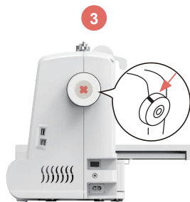
Setzen Sie das Handrad zurück und stellen Sie sicher, dass die Nadel auf dem höchsten Punkt ist
